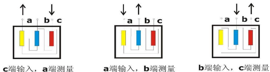
图 5 内连接 Δ 接线
