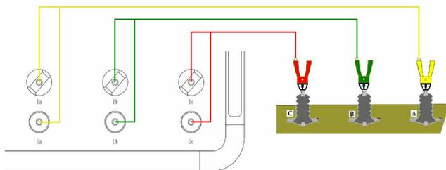
图 8 短路阻抗法接线（以三相变压器为例）
