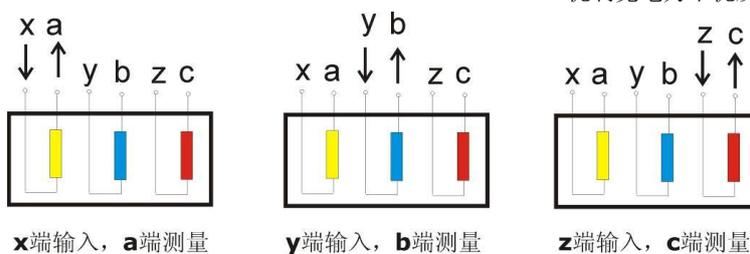
图 6 外连接  $\Delta$  接线
