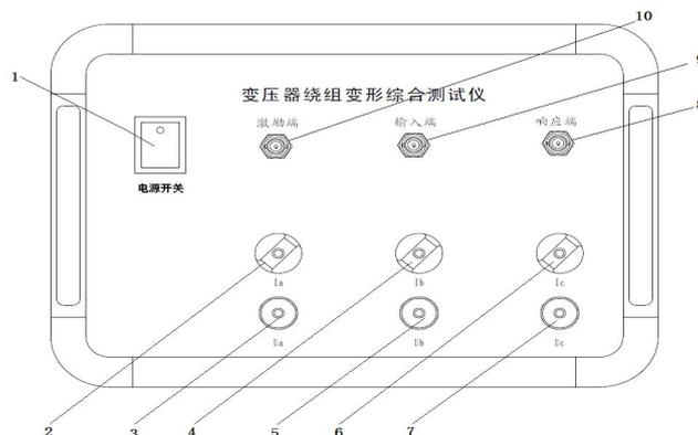
图 1 变压器绕组变形测试仪面板图
